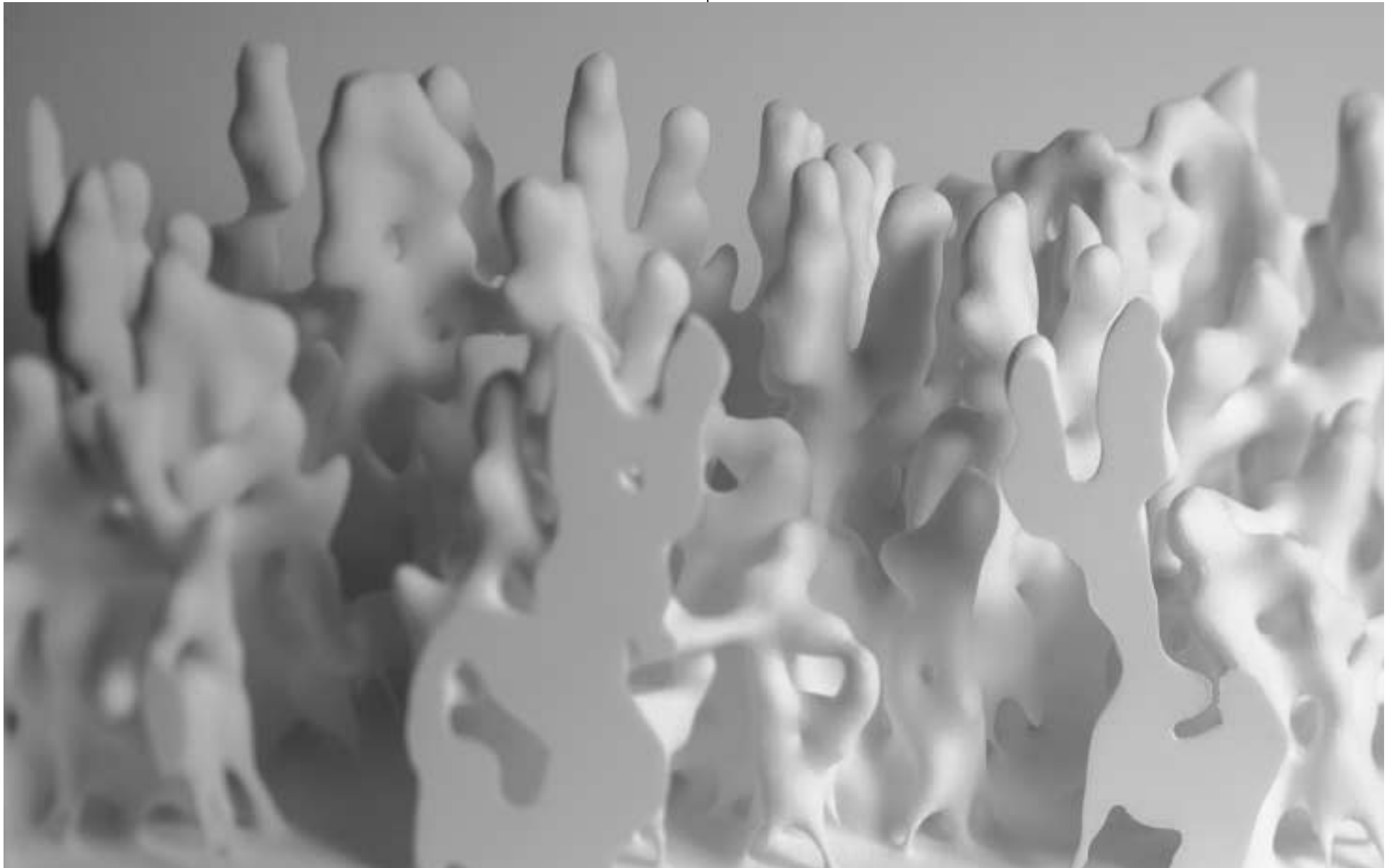
32 Matrice générique. Frittage par laser. Vue de profil SLS. 1/1000' Generic matrix. Side view. Model by laser sintering. Side View.
